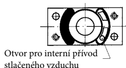
Obrázek 1 Těsnění v pozici pro interní přívod pomocného vzduchu
